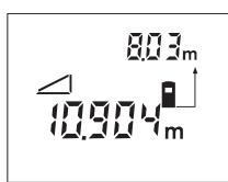
Po skončení druhého měření se automaticky vypočítá vzdálenost **B**. Poslední jednotlivá naměřená hodnota je na displeji dole, výsledek **B** nahoře.
