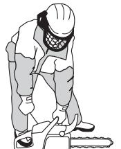
**UWAGA!** Nie wyciągaj linki rozrusznika całkowicie i nie puszczań jej nagle, gdy jest wyciągnięta. Może to spowodować uszkodzenie maszyny.
