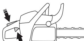
Zauważ! Przywróć hamulec łańcucha do stanu gotowości, odprowadzając ochronę przed odbiciem (oznaczoną "PULL BACK TO RESET") w stronę pałka uchwytu. Pilarka jest teraz gotowa do użycia.
