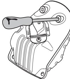
Niektoré tlmiče výfuku sú vybavené špeciálnou sietkou na zachytávanie iskier. Ak má vaša píla tento typ tlmiča, mali by ste sietku čistiť aspoň jedenkrát týždenne. Najlepšie sa sietka čistí drôtenou kefou. Zanesený zachytávač spôsobí prehriatie motora a môže zapríčiniť jeho vážne poškodenie.
