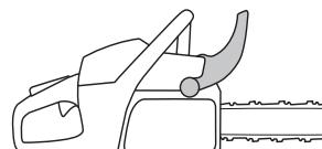
Podczas pracy maszyną zachowuj ostrożność i zapewnij, aby strefa odbicia prowadnicy nigdy nie dotykała do żadnego przedmiotu.
