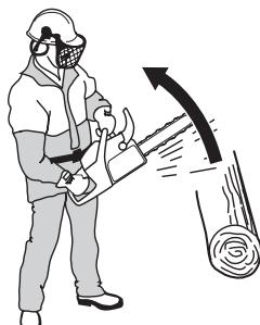
Odbicie powstaje wyłącznie w momencie zetknięcia się strefy odbicia prowadnicy z twardym przedmiotem.
