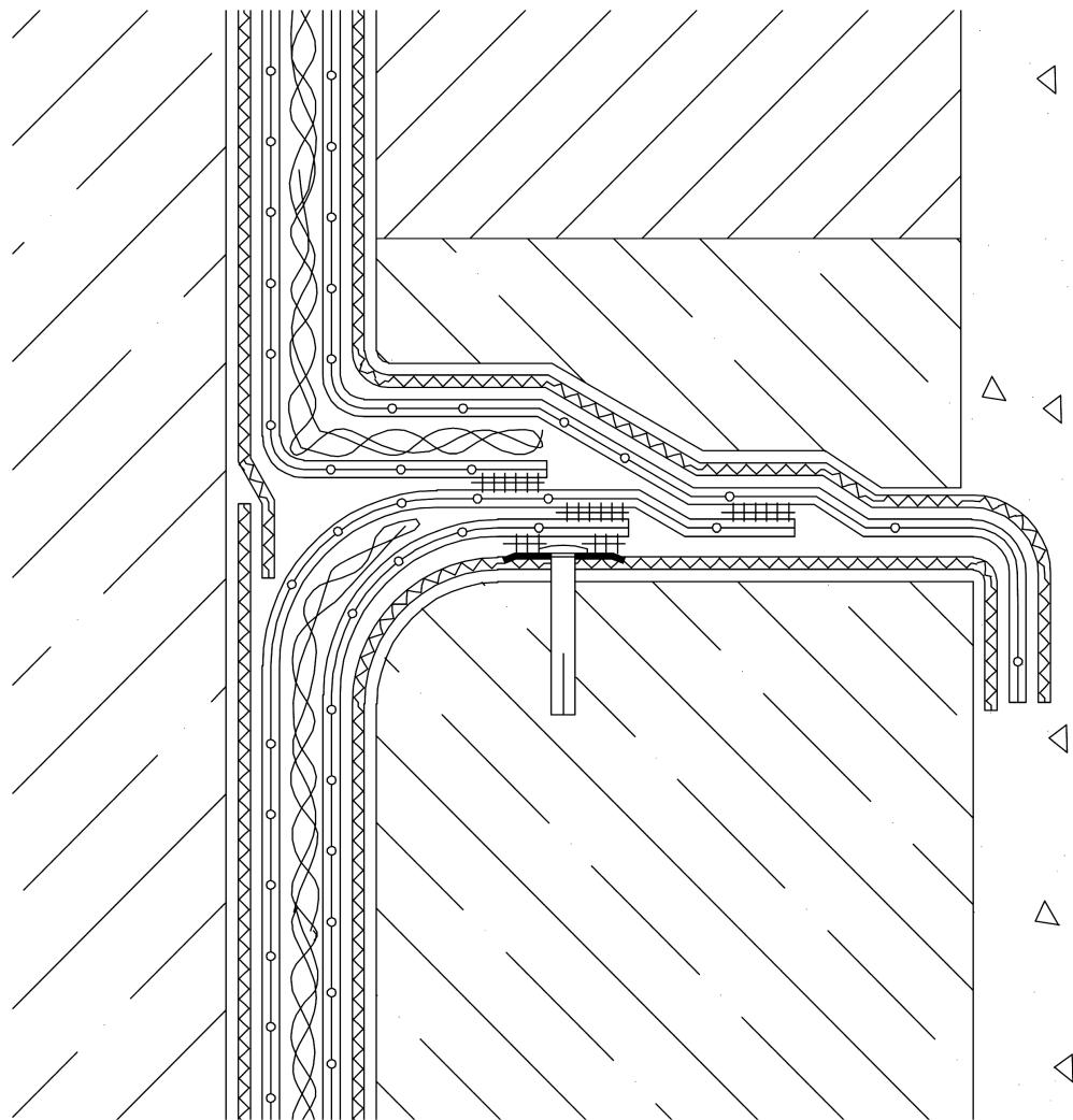
Schéma 16 - Napojení sektorové izolace v etapovém spoji na vrcholu pažení
