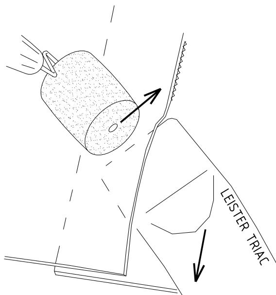
Schéma 4 - Práce s horkovzdušným přístrojem a válečkem
