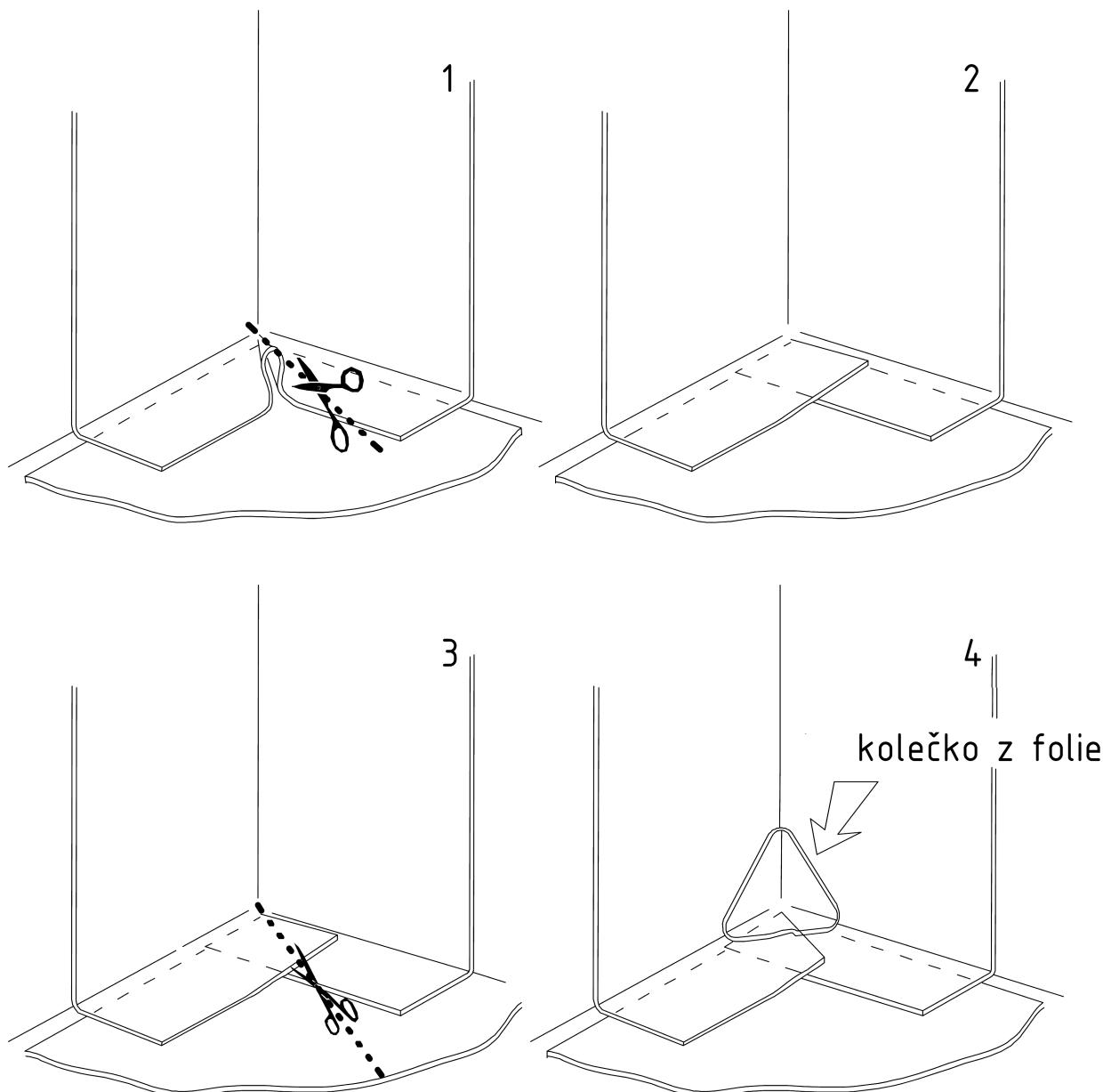
Schéma 8a - Provádění jednovrstvé izolace v koutu – provedení spojité vrstvy folie
