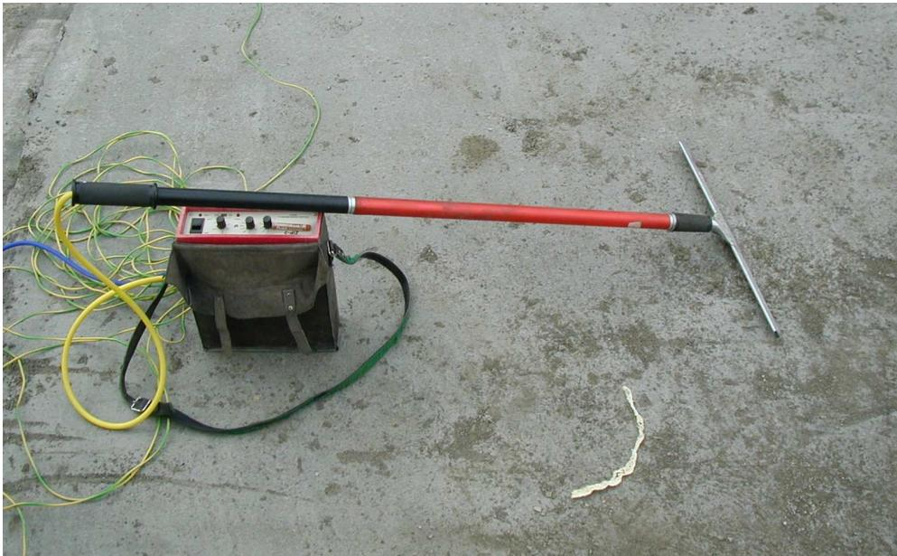
Foto 8. Poroskop - přístroj pro provádění jiskrové zkoušky.
