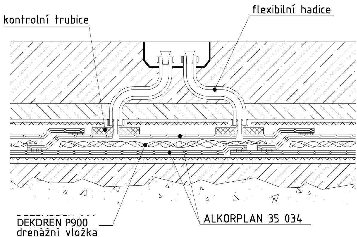
*Schéma 3 - Princip dvojitého systému s možností kontroly a aktivace
