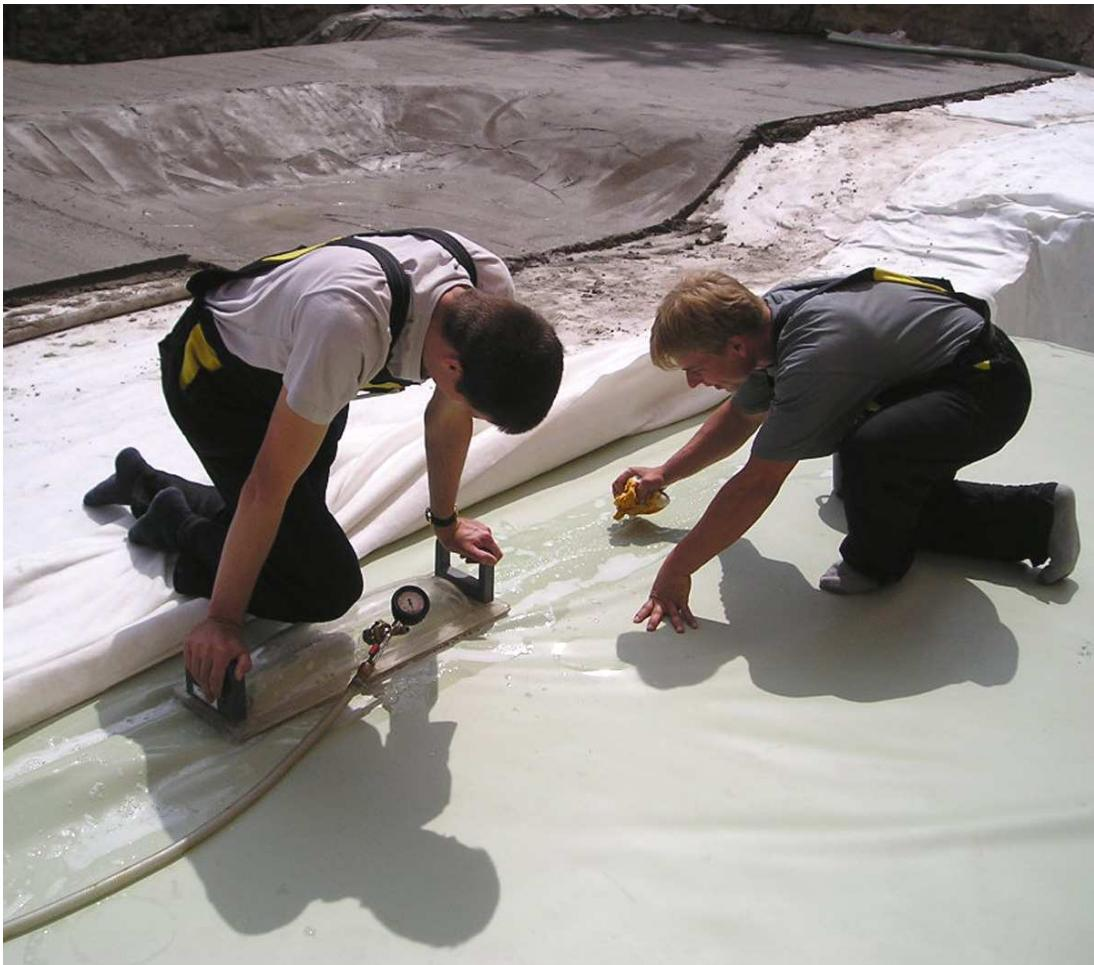
Foto 8. Zkoušení těsnosti spojů vakuovou zkouškou.
