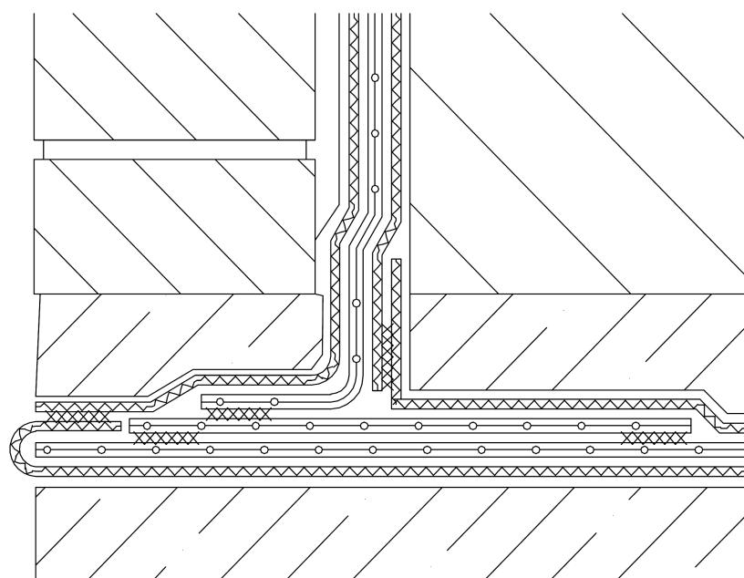
Schéma 10 - Etapy provádění zpětného spoje
