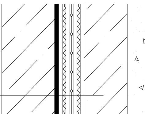
Schéma 7 - Ochrana svislé hydroizolace. A-B – hydroizolace prováděná z vnější stany objektu, C – ochrana hydroizolace s drenážní funkcí, D - hydroizolace prováděná na pažení
