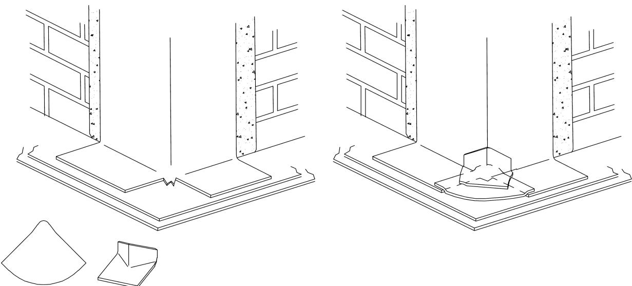
Schéma 9 - Provádění detailu zpětného spoje v rohu
