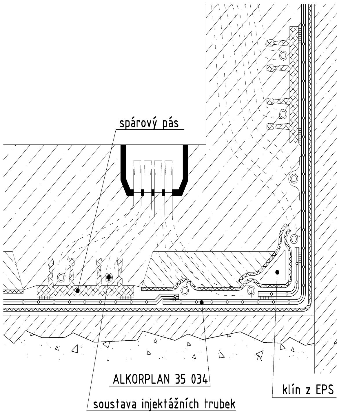
Schéma 2 - Princip jednovrstvého systému s možností sanace
