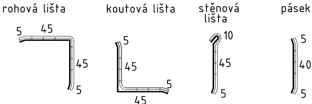
Schéma 1 - Typizované spojovací profily z plechu s vrstvou PVC-P
