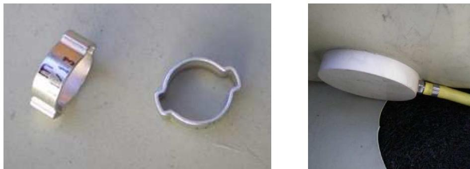
*Foto 5. Dvououšková objímka pro fixaci injektážní hadice (vpravo nainstalovaná)*
