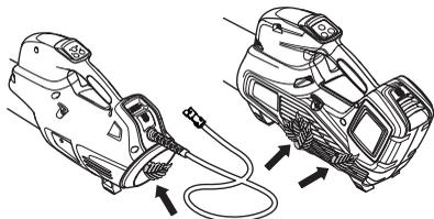
Sprawdź, czy wloty powietrza nie są zatkane z żadnej strony, np. przez liście lub śmieci. Zatkany wlot powietrza zmniejsza wydajność dmuchawy oraz powoduje podwyższenie temperatury silnika, co może doprowadzić do jego awarii. Wyłącz silnik i oczyść wlot powietrza.
