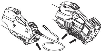
Ellenőrizze, nem takarja-e valami (pl. levelek vagy szemét) a levegőbeömlő nyílást valamelyik oldalon. Az levegőbeömlő nyílás eltömődése esetén csökken a lombfúvó teljesítménye, és megemelkedik a motor működési hőmérséklete, ami a motor meghibásodásához vezethet. Állítsa le a motort, és szüntesse meg az eltömődést.
