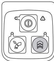
Pokud bude zvýšený proud vzduchu (Turbo) používán po dobu delší než 5 sekund, průtok vzduchu se vrátí na původní úroveň. Indikátor aktivace (kontrolka LED) pro funkci Turbo bude svítit, dokud nebude funkce Turbo opět k dispozici.
