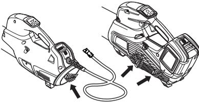
Prohlédněte stroj ze všech stran a ověřte, zda přívod vzduchu není ucpaný listy nebo jinými nečistotami. Ucpaný přívod vzduchu snižuje foukací kapacitu stroje a zvyšuje pracovní teplotu motoru, což může způsobit závadu motoru. Vypněte motor a odstraňte z přívodu vzduchu všechny překážky.
