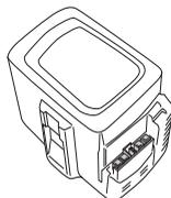
Akumulator i zaciski należy utrzymywać w czystości. Plastikowe części należy czyścić czystą i suchą ściereczką.
