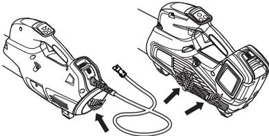
Na všetkých stranách zariadenia skontrolujte, či nie je zablokovaný prívod vzduchu, napríklad listami alebo nečistotami. Upchaný prívod vzduchu znižuje fúkaciu kapacitu stroja a zvyšuje pracovnú teplotu motora, čo môže spôsobiť poškodenie motora. Vypnite motor a predmet odstráňte.
