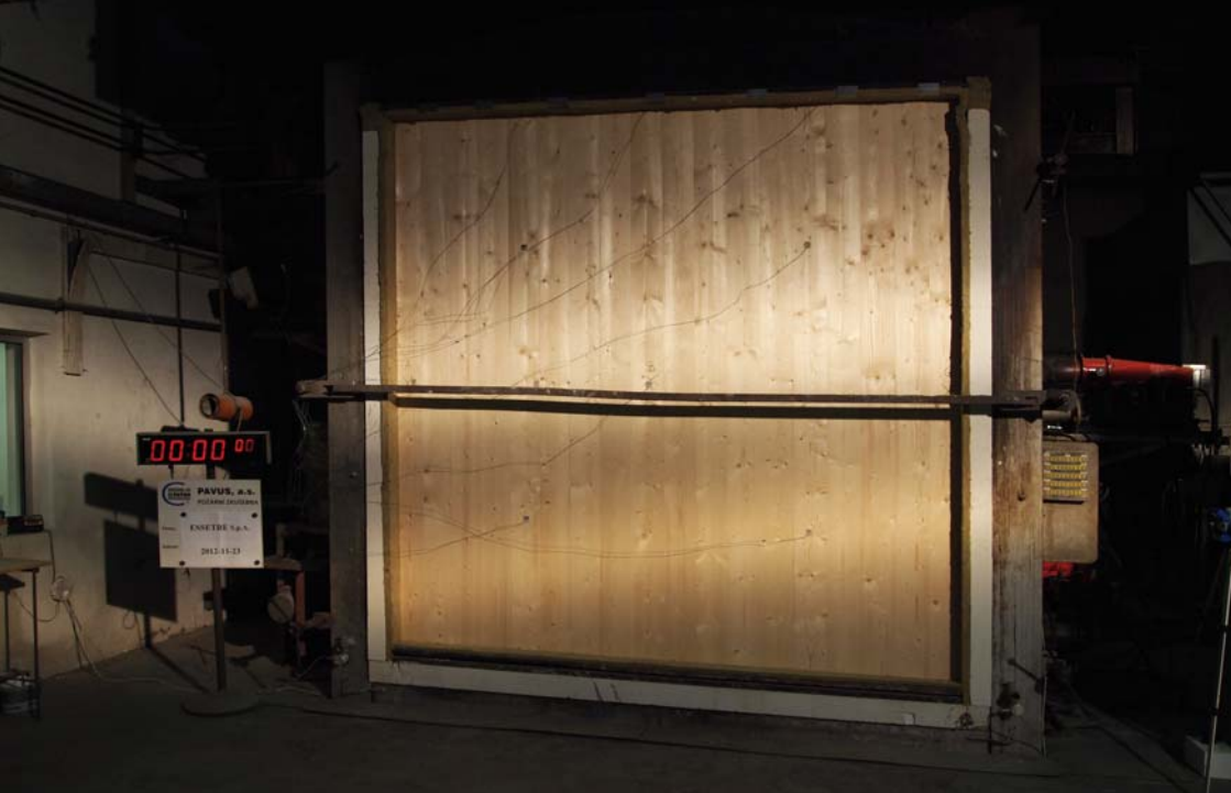
Zkušební DEKPANEL D 81 připravený na provedení požární zkušky
