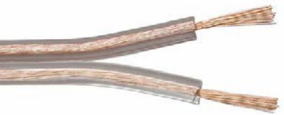
Kabel průhledný TLyP /SCY/ 2× plochý, pro přenos audio signálu, jmenovité napětí 50V, transparentní PVC izolace, jemně drátovaná měděná jádra, cena za bm
