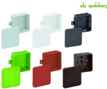
Krabice spojovací Spelsberg i12-L pro povrchovou instalaci, s děrovacím nástrojem a zaslepovací zátkou, krytí IP 55, materiál polypropylen
