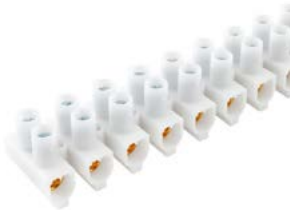
Svorkovnice instalační EKL 4 lámací, dvanáctipólová, pro průřez vodiče 10–25 mm², jmenovitý proud 101 A, jmenovité napětí 450 V, povrchově upravená ocel
