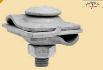
Svorka univerzální SU Uni pro spojení kruhových vodičů, FeZn, vratový šroub 1× M10, 2 příložky + 1 střed
