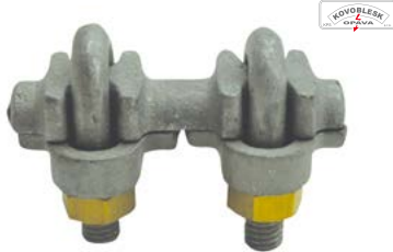
Svorka zkušební SZ pro spojení svodů hromosvodu s uzemněním, litina, mosazné matice 4× M8, pro ø vodiče 8–10 mm, rozměry 30×38 mm
