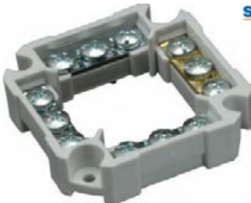
Svorkovnice krabicová 6303-13 P1/S bílá, čtyřpólová, 3 vodiče na pól, max. průřez vodiče 4 mm², jmenovité napětí 450 V, šířka 58 mm
