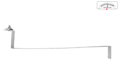
Podpěra vedení PV 11b na taškové střechy, materiál FeZn, vzdálenost vodiče od povrchu 100 mm, délka pásky 430 mm
