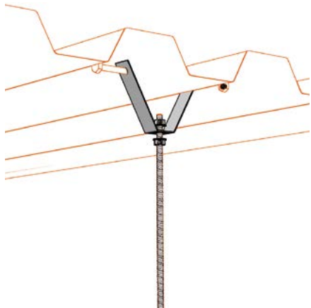
Držák závitové tyče ARKYS DZM 5 pro ukotvení závitových tyčí M8 do střešních podhledů tvořených trapézovými plechy, galvanicky zinkováno
