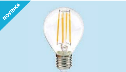
Žárovka LED Claro patice E27, napětí 230 V 4 W 400 lm 2 700 K A+
