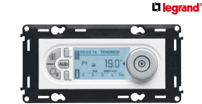
Termostat programovatelný podlahový Legrand Valena Life digitální, včetně podlahové sondy 4 m, spínací kontakt 16A, regulace 7–30 °C, barva bílá, barva bílá
