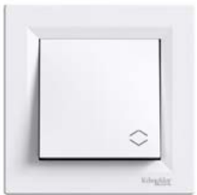
Přepínač střídavý Schneider Asfora řazení 6, bezšroubové svorky, jmenovitý proud 10A, včetně rámečku, barva bílá
