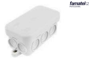
Krabice rozbočovací K6 pro povrchovou instalaci, krytí IP 54, odolnost proti mechanickým rázům IK 07, UV odolná, bezhalogenová, šířka 80 mm, výška 43 mm, hloubka 36 mm
