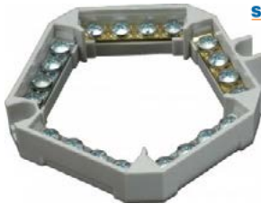
Svorkovnice krabicová 6304-15 P/S šedivá, pětipólová, 4 vodiče na pól, max. průřez vodiče 4 mm², jmenovité napětí 450 V, šířka 95 mm
