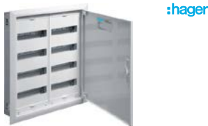
Rozváděč zapuštěný FW II Hager FW42US1 pro zapuštěnou montáž, oceloplechový, třída ochrany II, krytí IP 30, barva bílá, počet řad 4, 96 modulů, šířka 550 mm, výška 650 mm, hloubka 110 mm
