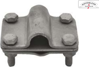
Svorka k jímací tyči SJ 01 pro připojení kruhového vodiče průměru 8–10 mm k jímací tyči průměru 16 mm, materiál FeZn, 4× M8, rozměry 90×65 mm
