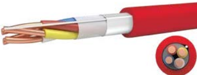
Kabel sdělovací J-Y(St)Y pro požární signalizaci, sdělovací, stíněný laminovanou Al fólií, třída reakce na oheň E ca , měděná jádra, ø jádra vodičů 0,8 mm
