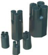
Hlava rozdělovací smršťovací EN 4.3 teplem smrštitelná >135 °C, 4 žilové výstupy, síla stěny 4,2/2,5 mm, kabelový vstup 60/25 mm, žilový výstup 25/8 mm, délka žilových výstupů 150/32 mm, rozsah použití 50–150 mm²
