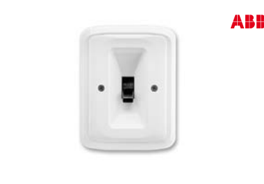
Spínač třípólový kompletní ABB Tango šroubové svorky, s propojovací svorkou N a PE, jmenovitý proud 16A, jmenovité napětí 400V, včetně instalační krabice, barva bílá
