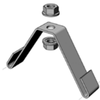
Držák žlabu ARKYS DZM 3/100 pro zavěšení kabelových žlabů šířky 100 mm na závitové tyče M8, lze jej využít i jako nosný prvek pro instalaci různých typů svítidel, galvanicky zinkováno
