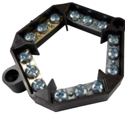
Svorkovnice krabicová 1608803 černá, pětipólová, 3 vodiče na pól, max. průřez vodiče 4 mm², jmenovité napětí 660 V, šířka 82,5 mm
