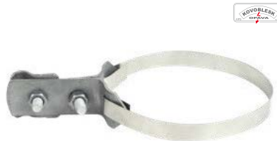
Svorka na okapové roury ST uni pro připojení kruhových vodičů k okapovým svodům, pro ø 100–200 mm, materiál FeZn, nerezová páska, délka 800 mm
