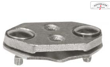
Svorka zemnicí SR 03 S pro souběžné spojení zemnicí pásy a kruhového vodiče hromosvodu, materiál litina
