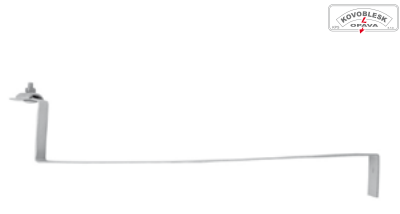
Podpěra vedení PV 11b na taškové střechy, materiál FeZn, vzdálenost vodiče od povrchu 100 mm, délka pásky 220 mm
