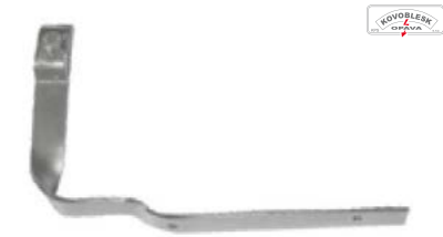
Podpěra vedení PV 22 točená na taškové a eternitové střechy, materiál FeZn, vzdálenost vodiče od povrchu 115 mm, délka pásky 200 mm
