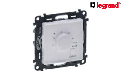
Termostat podlahový Legrand Valena Life analogový, včetně podlahové sondy 4 m, spínací kontakt 16A, regulace 7–30 °C, barva bílá
