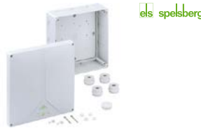
Krabice rozbočovací Spelsberg ABOX 350 pro povrchovou instalaci, předlisý pro vývodky M40 (IP 54), zaslepovací zátky, krytí IP 65, ochrana před mechanickými rázy IK 07, šířka 250 mm, výška 250 mm, hloubka 115 mm
