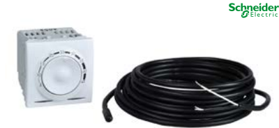
Termostat otočný podlahový Schneider Unica Polar analogový, včetně podlahové sondy 4 m, regulace 5–45 °C, 2× LED podsvícení (zelená = napětí, červená = topení), max. zátěž 10A (odporová), barva bílá
