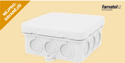
Krabice rozbočovací K12 pro povrchovou instalaci, krytí IP 54, odolnost proti mechanickým rázům IK 07, UV odolná, bezhalogenová, šířka 85 mm, výška 85 mm, hloubka 40 mm
