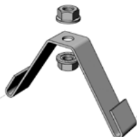
Držák žlabu ARKYS DZM 3/150 pro zavěšení kabelových žlabů šířky 150 mm na závitové tyče M8, lze jej využít i jako nosný prvek pro instalaci různých typů svítidel, galvanicky zinkováno
