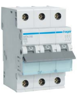
Jistič 6 kA 3pól char. C Hager MCN třípólový, vypínací charakteristika C, zkratová vypínací schopnost 6 kA
