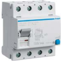
Proudový chránič 4pól typ B Hager CDB440D čtyřpólový, jmenovitý reziduální proud 30 mA, jmenovitý podmíněný zkratový proud 10 kA, typ B, jmenovitý proud 40 A
