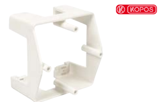
Krabice přístrojová pro parapetní kanál Kopos KP PK HB pro uchycení přístrojů (zásuvek, spínačů...) včetně rámečků a dvojzásuvek, určeno pro parapetní kanály PK, materiál PVC, 10 ks/bal.
