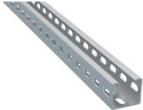
Stojna prostorová ARKYS STPM 3000 pro vytvoření prostorových nosných konstrukcí pro kabelové trasy, tloušťka materiálu 2 mm, délka 3 m, hmotnost 4,5 kg
