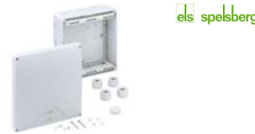
Krabice rozbočovací Spelsberg ABOX 350 pro povrchovou instalaci, 5pólová šroubová svorkovnice, předlisý pro vývodky M40 (IP 54), zaslepovací zátky, krytí IP 65, ochrana před mechanickými rázy IK 07, max. průřez vodiče 35 mm², šířka 250 mm, výška 250 mm, hloubka 115 mm
