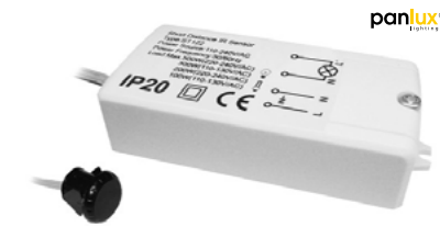
Spínač senzorový dveřní bezdotykový, zhasnutí při zavření dveří, kabel zakončený svorkovnicí, vyzařovací úhel 60°, napájení 230 V AC, třída ochrany II, krytí IP 20, materiál plast, barva bílá
