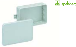
Krabice rozbočovací Spelsberg i16-L pro povrchovou instalaci, s děrovacím nástrojem a zaslepovací zátkou, krytí IP 55, materiál polypropylen, šířka 130 mm, výška 85 mm, hloubka 37 mm
