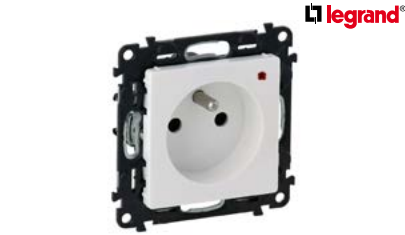
Zásuvka jednonásobná s přepětovou ochranou Legrand Valena Life 2P+T, bezšroubové svorky, jmenovitý proud 16A, s přepětovou ochranou, barva bílá
