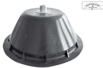
Podstavec pro jímací tyč betonový podstavec se závitem M16, ø podstavce 350 mm, PVC podložka, hmotnost 12 kg
