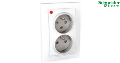
Zásuvka dvojnásobná s přepětovou ochranou Schneider Unica Polar s přepětovou ochranou, 2× 2P+T, jmenovitý proud 16A, barva bílá
