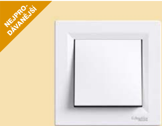
Spínač jednopólový Schneider Asfora řazení 1, bezšroubové svorky, jmenovitý proud 10A, včetně rámečku, barva bílá
