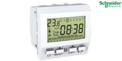
Termostat programovatelný Schneider Unica Polar digitální, týdenní program, regulace 5–35 °C, max. zátěž 5A/8A (induktivní = pouze prostor/odporová), záloha chodu 7 dní, barva bílá
