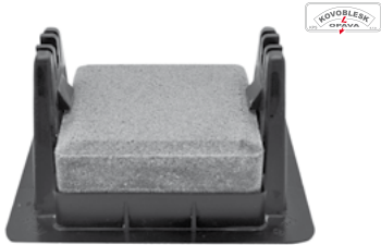
Podpěra vedení PV 21d na ploché střechy, dvojitý plastový zámek, vzdálenost vodiče od povrchu 65 mm, pro ø vodiče 8–10 mm, hmotnost 1 kg
