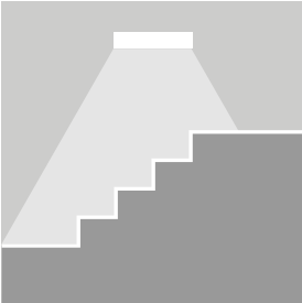
V blízkosti schodiště, tak aby každé schodišťové rameno bylo osvětleno
