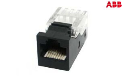
Keystone RJ45 CAT 5E ABB pro uchycení do nosných masek ABB, nestíněný, kategorie CAT5e, samořezný
