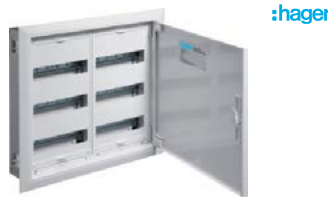
Rozváděč zapuštěný Hager FW32US1 pro zapuštěnou montáž, oceloplechový, třída ochrany II, krytí IP 30, barva bílá, 3 řady, 72 modulů, šířka 550 mm, výška 550 mm, hloubka 110 mm
