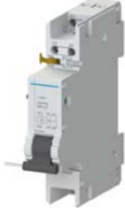
Spoušť podpěťová OEZ SP-LT-A230 pro přidání z pravého boku jističe, k vypnutí přístroje při ztrátě nebo poklesu napětí
