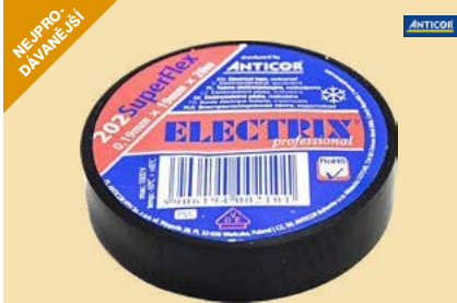
Páska Anticor 202 Electrix Superflex Ize použit pro mechanickou ochranu petrolátové pásky 701-40 a elektrickou izolaci kabelů nízkého napětí i pod zemí, elastická, samozhášivá, materiál PVC, délka 20 m, tloušťka 0,19mm
