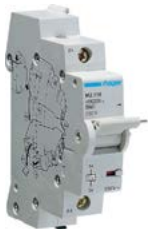
Spoušť podpětíová Hager MZ206 pro přidání z boku jističe, k vypnutí přístroje při ztrátě nebo poklesu napětí, jmenovité napětí 230 V, jmenovité izolační napětí 4 kV, vypínací čas 200 ms
