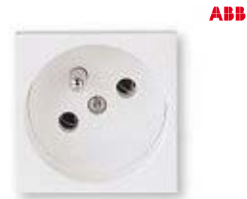
Zásuvka profil 45 ABB jmenovitý proud 16 A, upevnění zacvaknutím, šroubové svorky (pro vodiče 1,5-2,5 mm 2 ), rozměry 45×45 mm
