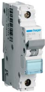
Jistič 10 kA 1pól char. B Hager NBN jednopolový, vypínací charakteristika B, zkratová vypínací schopnost 10 kA
