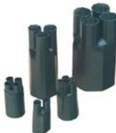
Hlava rozdělovací smršťovací EN 4.1 teplem smrštitelná >135 °C, 4 žilové výstupy, síla stěny 2,5/1,8 mm, kabelový vstup 35/15 mm, žilový výstup 13/4 mm, délka žilových výstupů 80/20 mm, rozsah použití 6–50 mm²
