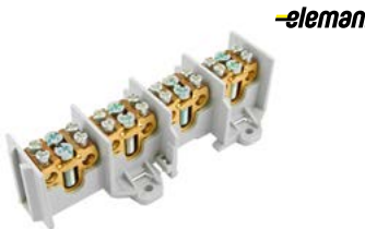
Svorkovnice stoupací HAK/4/35 4pólová, pro stoupací vedení, bez nutnosti přerušení vodiče, max. průřez vodiče 35 mm², bez krytu, krytí IP 00, 4× výstup max. 25 mm² na pól, jmenovitý proud 100 A
