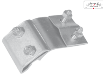
Svorka okapová SO velká pro připojení kruhového vodiče k okapovým žlabům, materiál FeZn, rozměry 55×90 mm
