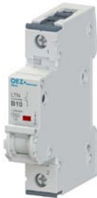
Jistič 10 kA 1pól char. B OEZ LTN jednopolový, vypínací charakteristika B, zkratová vypínací schopnost 10 kA
