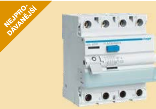
Chránič proudový 4pól 25 A Hager CDA425D čtyřpólový, jmenovitý reziduální proud 30 mA, typ A, jmenovitý podmíněný zkratový proud 6 kA, jmenovitý proud 25 A
