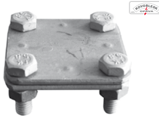
Svorka odbočovací/připojovací SR 02 pro křížové a souběžné spojení zemnicí pásy, materiál FeZn, rozměry 55×55 mm
