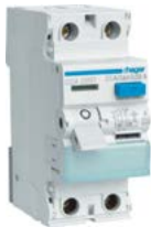
Chránič proudový 2pól 25 A Hager CDB440D dvoupólový, jmenovitý reziduální proud 30 mA, typ A, jmenovitý podmíněný zkratový proud 6 kA, jmenovitý proud 25 A
