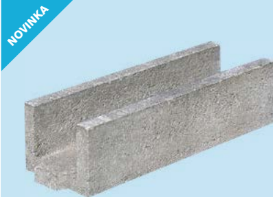
Žlab kabelový KZ betonový, ke krytí uložených rozvodů elektroinstalace a telekomunikace v zemi, třída betonu C 25/30-XF1, délka 500 mm
