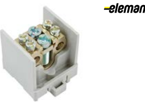
Svorkovnice stoupací HAK/1/35 1pólová, pro stoupací vedení, bez nutnosti přerušení vodiče, max. průřez vodiče 35 mm², bez krytu, krytí IP 00, 4× výstup max. 25 mm² na pól, jmenovitý proud 100 A
