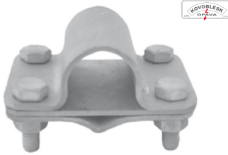
Svorka k zemnicí tyči SJ 02 pro připojení kruhového vodiče průměru 8–10 mm k jímací tyči průměru 25 mm, materiál FeZn, 4× M8, materiál FeZn
