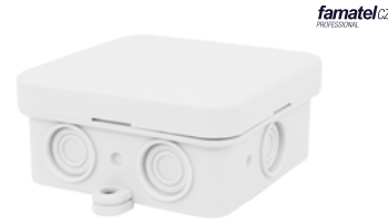
Krabice rozbočovací K8 pro povrchovou instalaci, krytí IP 54, odolnost proti mechanickým rázům IK 07, UV odolná, bezhalogenová, šířka 75 mm, výška 75 mm, hloubka 36 mm
