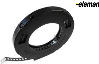
Páska montážní MP 12×0,75 kovová (pozinkovaná), perforovaná, ø otvoru 5 mm pro hmoždinku 5×35, šířka 12 mm, délka 10 m, tloušťka 0,75 mm
