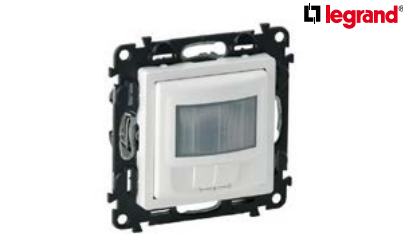
Pohybové čidlo Legrand Valena Life vypínatelný, max. spínaná zátěž 3–250 W (3–100 W pro LED a zářivky), doba sepnutí 10 s – 10 min, rozsah 5–1 275 lx, barva bílá
