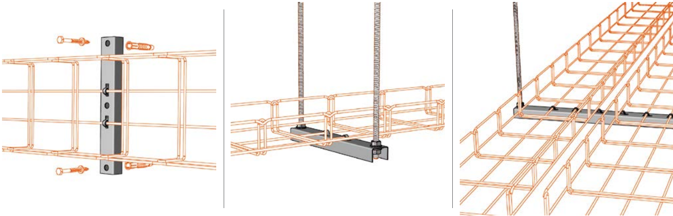
Podpěra žlabů ARKYS PZM pro uchycení na závitové tyče, galvanicky zinkováno, plech tloušťky 1 mm, bezšroubové úchyty
