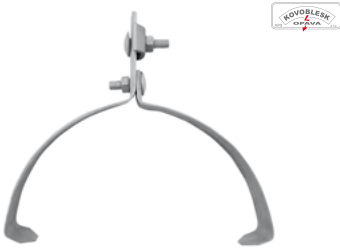
Podpěra vedení PV 15 Beta materiál FeZn, délka 230 mm, výška 100 mm, pro hřebenáče KM BETA, Bramac, Betonpres
