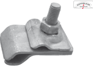
Svorka okapová SO malá pro připojení kruhového vodiče k okapovým žlabům, materiál FeZn, rozměry 55×40 mm
