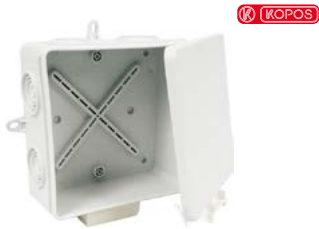
Krabice s krytím IP 54 Kopos 8135 KA pro povrchovou instalaci, krytí IP 54, ochrana proti mechanickým rázům IK 06, šířka 110 mm, výška 110, hloubka 49 mm
