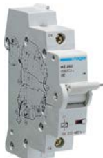
Spoušť jističe pracovní Hager MZ203 pro přidání z boku jističe, externí vypnutí jističe přivedeným napětím, doba aktivace 200 ms, jmenovité napětí 230/415 V AC, 110–130 V DC
