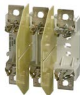
Spodek pojistkový 3pól OEZ S3PB00SS třípólový, s plastovou základnou, pro pojistkové vložky velikosti 000 a 00, jmenovité pracovní napětí 690 V, jmenovitý proud 160 A
