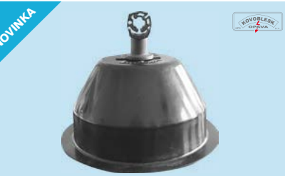
Podpěra vedení PV 21c/100 na ploché střechy, plastový zámek, vzdálenost vodiče od povrchu 100 mm, pro ø vodiče 8–10 mm, hmotnost 1 kg
