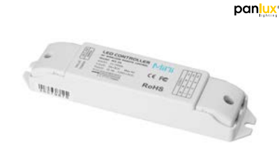
Přijímač/Reciever samostatný přijímač pro Ovládač Mini, třída ochrany III, krytí IP 20, jmenovité napětí 12/24 V, provozní teplota -10 až +40 °C, materiál plast
