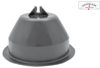
Podpěra vedení PV 21c na ploché střechy, plastový zámek, vzdálenost vodiče od povrchu 65 mm, pro ø vodiče 8–10 mm, hmotnost 1 kg
