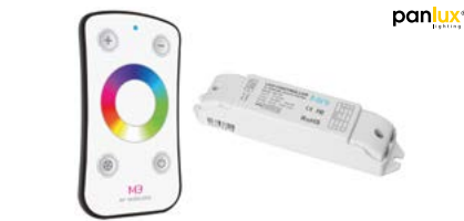
Ovládač Mini RGB ovládání barvy světla ve spektru RGB, magnetická zadní strana, dosah 30 m, třída ochrany III, krytí IP 20, provozní teplota -10 až +40 °C, materiál plast, přijímač součástí balení
