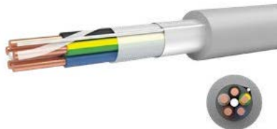
Kabel ovládací JYTY-O ovládací, stíněný laminovanou Al fólií, třída reakce na oheň E ca , pevná kruhová měděná jádra
