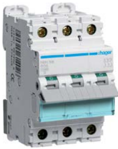
Jistič 10 kA 3pól char. B Hager NBN třípólový, vypínací charakteristika B, zkratová vypínací schopnost 10 kA
