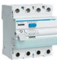
Chránič proudový 4pól 40 A Hager CDA440D čtyřpólový, jmenovitý reziduální proud 30 mA, typ A, jmenovitý podmíněný zkratový proud 6 kA, jmenovitý proud 40 A
