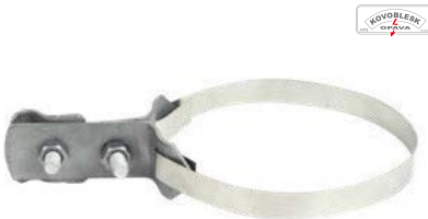
Svorka na okapové roury ST uni pro připojení kruhových vodičů k okapovým svodům, materiál FeZn, nerezová páska, délka 400 mm
