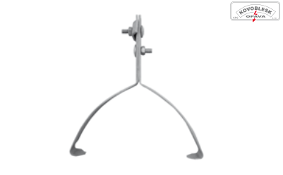
Podpěra vedení PV 15 Uni materiál FeZn, doporučený ø vodiče 8–10 mm, délka 220 mm, výška 110 mm, pro hřebenáče Tondach, Cembit
