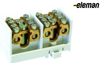
Svorkovnice stoupací HAK/2/35 2pólová, pro stoupací vedení, bez nutnosti přerušení vodiče, max. průřez vodiče 35 mm², bez krytu, krytí IP 00, 4× výstup max. 25 mm² na pól, jmenovitý proud 100 A
