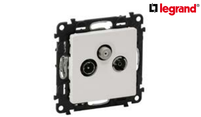
Zásuvka TV/R/SAT průběžná Legrand Valena Life průběžná, útlum 1,5 dB, oddělovací útlum 14 dB, barva bílá
