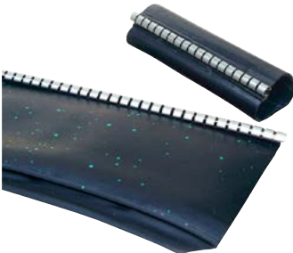
Manžeta opravná smršťovací SM nerezová zámková lišta, pro kabely do 1 kV, UV odolná, dielektrická pevnost 12 kV, délka před smrštním 0,5 m
