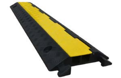
Přejezd kabelový pro ochranu vodičů, kabelů, trubek a hadic v silniční dopravě, materiál těžká vulkanizovaná pryž, násobné spojování čep/drážka, úchyt pro přemístění, možnost připevnění k podkladu šrouby
