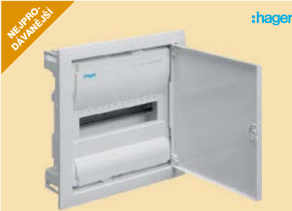
Rozvodnice Hager Volta VU pro zapuštěnou montáž, třída ochrany II, krytí IP 30, materiál plast, oceloplechová dvířka, barva bílá, šířka 348 mm, hloubka 94,5 mm
