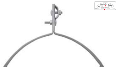
Podpěra vedení PV 15 Tondach materiál FeZn, doporučený ø vodiče 8–10 mm, délka 260 mm, výška 100 mm, pro hřebenáče Tondach
