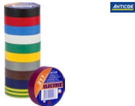
Páska Anticor 211 Electrix pro elektrickou izolaci kabelů nízkého napětí, elastická, PVC, samozhášivá, šířka 15 mm, délka 10 m, tloušťka 0,13 mm, různé barvy, 10 ks/bal.
