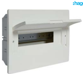
Rozvodnice Hager Cosmos VR pro zapuštěnou montáž, třída ochrany II, krytí IP 40, barva bílá, hloubka 72 mm
