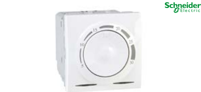
Termostat otočný Schneider Unica Polar analogový, regulace 5–30 °C, 2× LED podsvícení (zelená = napětí, červená/modrá = topení/klimatizace), max. zátěž 5A/8A (indukční/odporová), barva bílá
