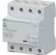
Chránič proudový 4pól 25 A OEZ LFN-25-4-030A-G čtyřpólový, jmenovitý reziduální proud 30 mA, typ AC, jmenovitý podmíněný zkratový proud 10 kA, jmenovitý proud 25 A
