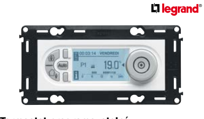
Termostat programovatelný Legrand Valena Life digitální, prostorový, včetně instalační krabice, 5modulový, regulace 7–30 °C, kontakty (max. 8 A) 1× spínaný 1× rozpinaný barva bílá
