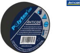
Páska vulkanizační silikonová Anticor 550 Polytex samosvařitelná, silikonová, odolná vůči vodě, olejům, rozpouštědlům, atd., teplotní rozsah –60 až +260 °C, max. provozní tlak 8 bar, elastická, barva černá, šířka 25 mm, tloušťka 0,5 mm, délka 3 m
