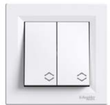
Přepínač střídavý dvojitý Schneider Asfora řazení 6+6, bezšroubové svorky, jmenovitý proud 10A, včetně rámečku, barva bílá
